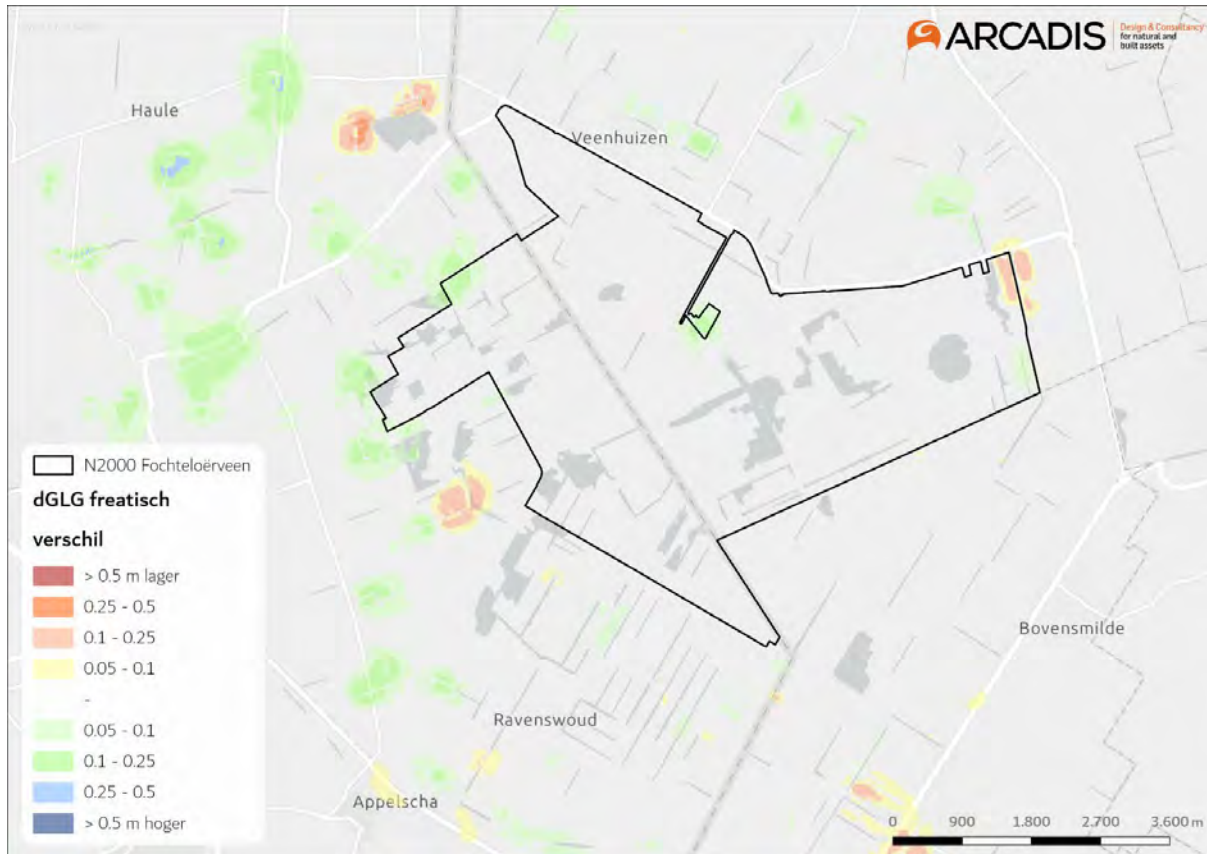
Figuur 7-9 Verandering van de GLG in het freatisch pakket door het belemen van watergangen die door keileem heen gegraven zijn.
