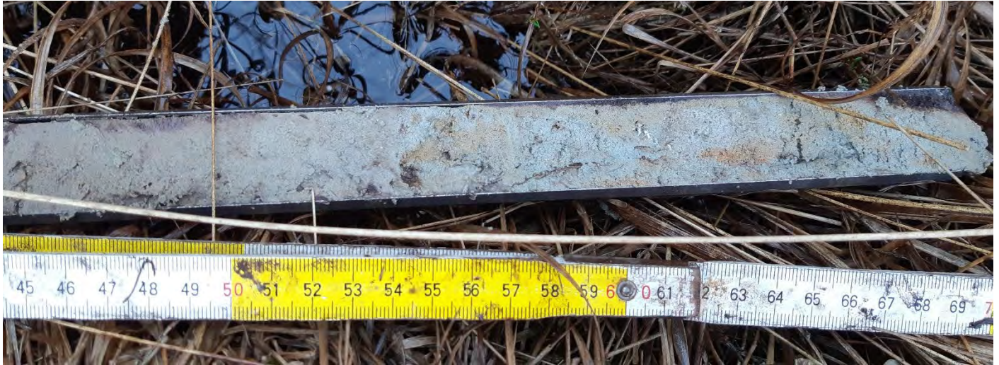
Figuur 11-50 Grondboring met keileem ten zuiden van het centrale compartiment
