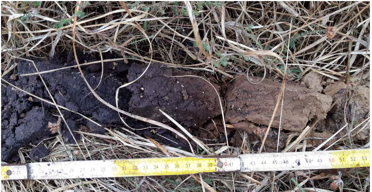
Figuur 11-49 Grondboring in het Kolonieveld met een podzol met een verkitte B-horizont. In de oorspronkelijke Ah en E horizont is eveneens disperse humus ingespoeld. Deze gliede verhoogt de weerstand van de bodem tegen infiltratie verder
