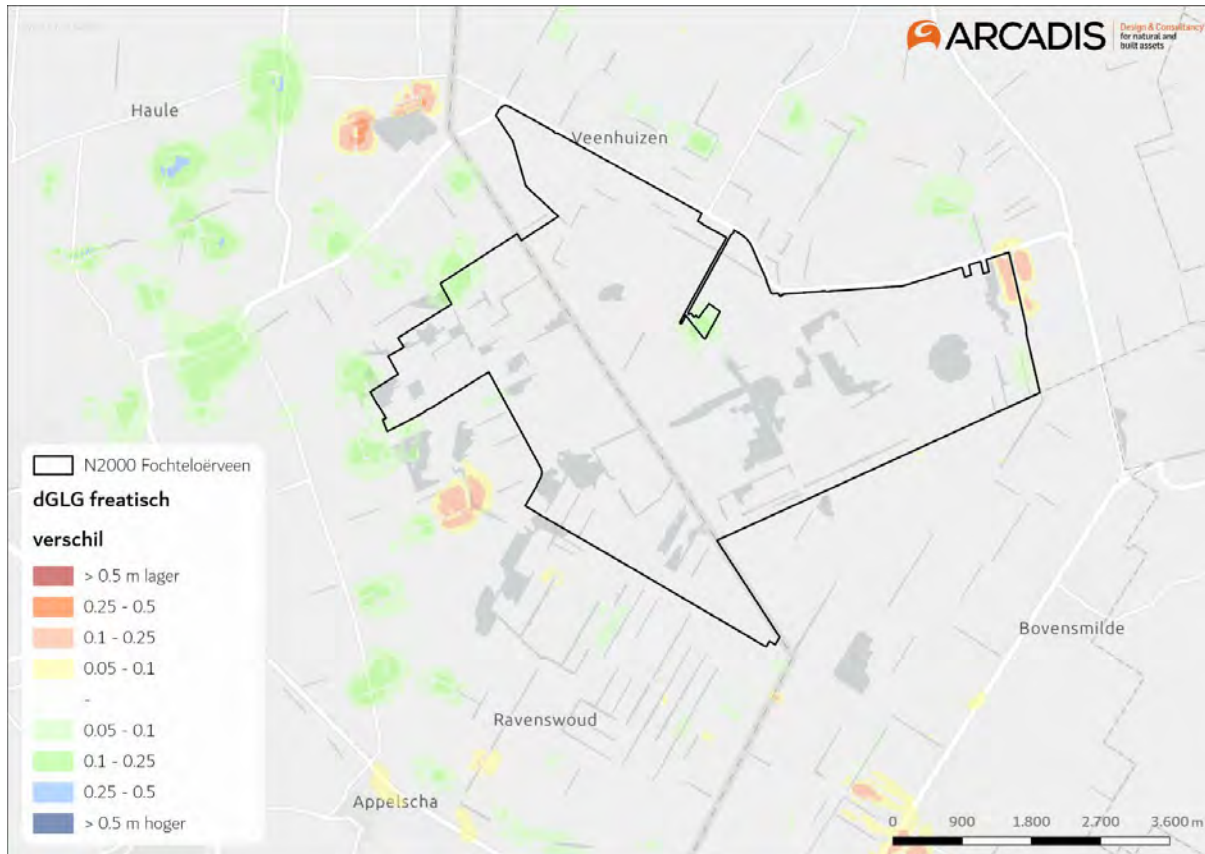
Figuur 7-9 Verandering van de GLG in het freatic pakket door het belemen van watergangen die door keileem heen gegraven zijn.
