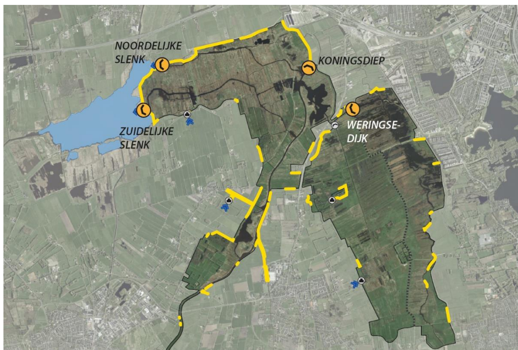
Figuur 3-1 Aanpassingen aan drempels, stuwen (oranje gekleurde symbolen) en kades (gele lijnen).
