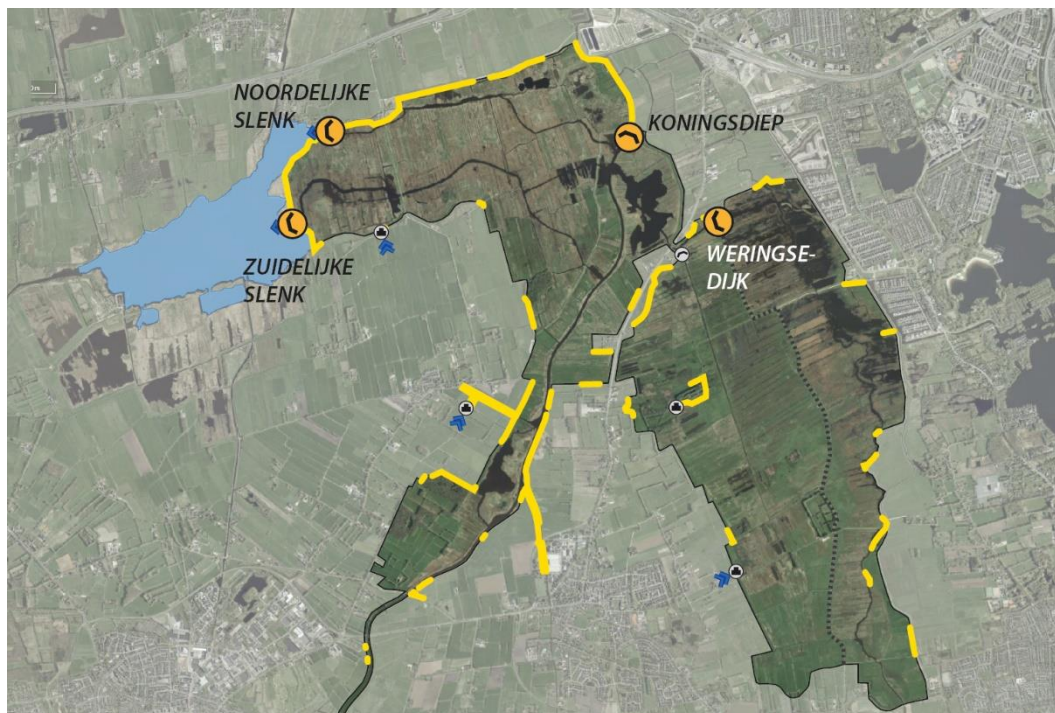
Figuur 3-1 Aanpassingen aan drempels, stuwens (oranje gekleurde symbolen) en kades (gele lijnen) oplossingsrichting Droge Voeten 2050.
